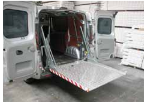
Danach heben Sie die Ladebordwand bis zum Fahrzeugboden an, um Ihre Ladung auf gleicher Höhe ins Fahrzeug zu schieben.
